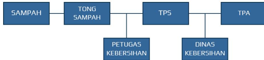
GambarIII.27. Skema sistem pembuangan sampah
