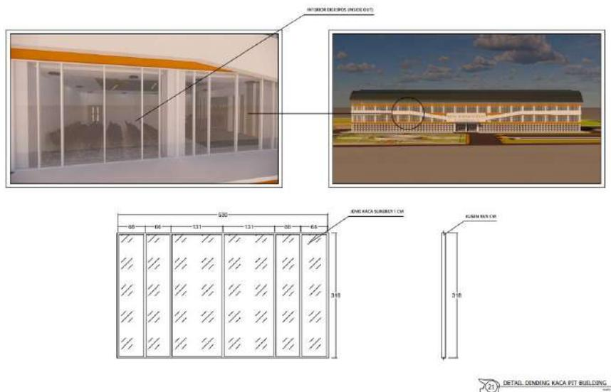
Gambar VI.21 Detail Pengungkapan Interior & Material Bangunan Pit Building
