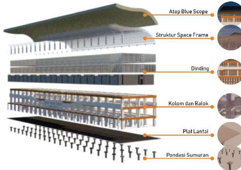
Gambar V.4 Struktur Bangunan
