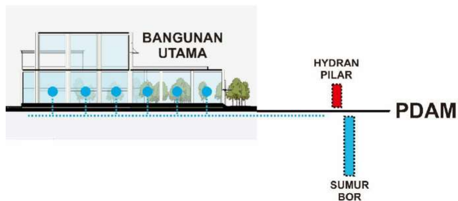
Gambar IV. 11 Sistem Pencegahan Kebakaran Sumber : Olah Data, 2022
