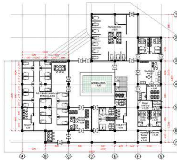
Gambar VI. 2 Denah Gedung 1 Lantai 1 Sumber: Olah Desain,2023
