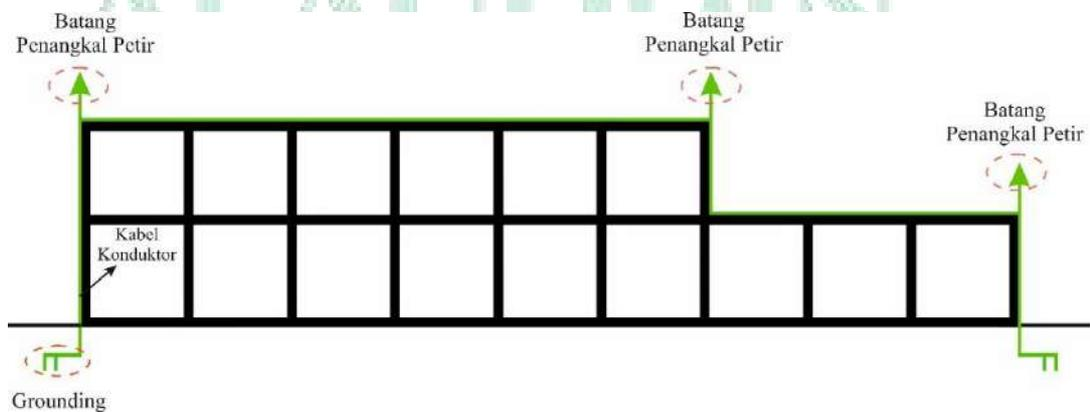
Gambar 4. 9 Sistem Penangkal Petir
