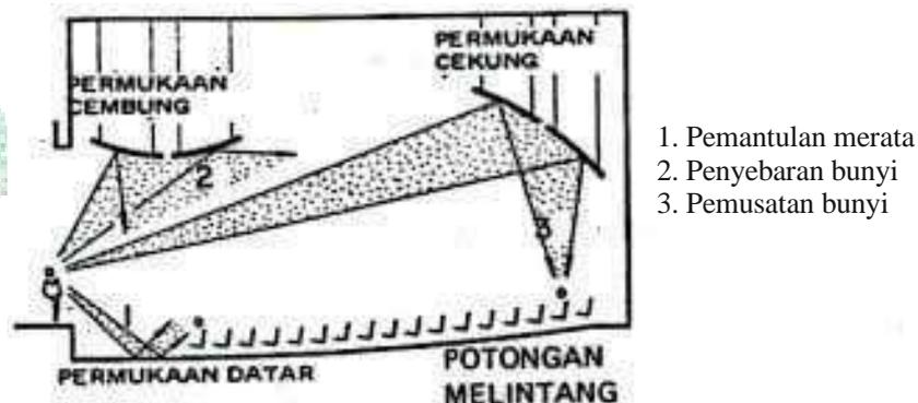
Gambar 2. 2 Pemantulan Bunyi dari Permukaan yang Berbeda
