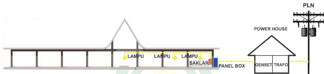
Gambar IV. 9. Sistem Jaringan Listrik Sumber : (Olah Data, 2023)
