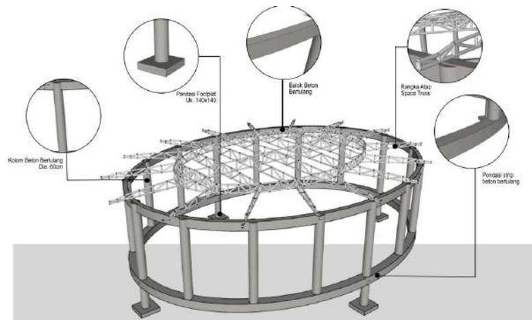
**Gambar 5. 6** Gagasan desain akhir struktur
