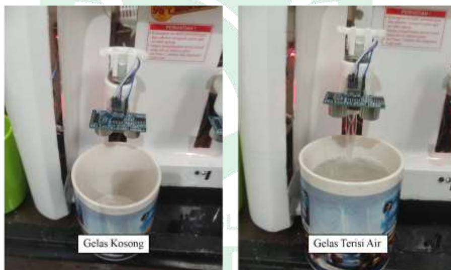
Gambar V.12. Sensor Ultrasonik Untuk Pengisian Air Otomatis.
