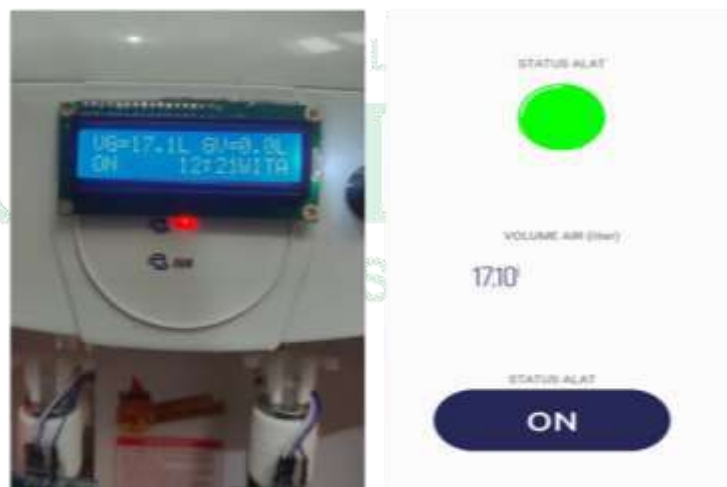
Gambar V.21. Pengujian LCD dan aplikasi mobile.
