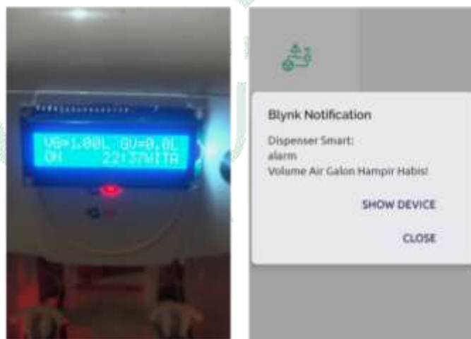
Pengujian alat dan Aplikasi Mobile untuk volume 19L air pada galon
