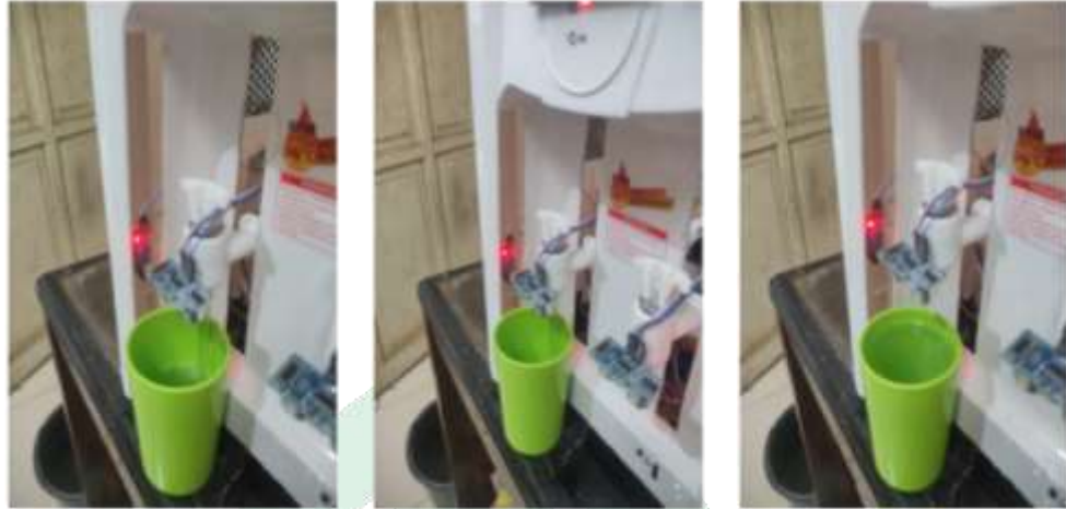
Gambar V.19. Pengujian sensor IR 2 untuk membaca ketinggian gelas dan sensor ultrasonic untuk membaca ketinggian air pada gelas.
