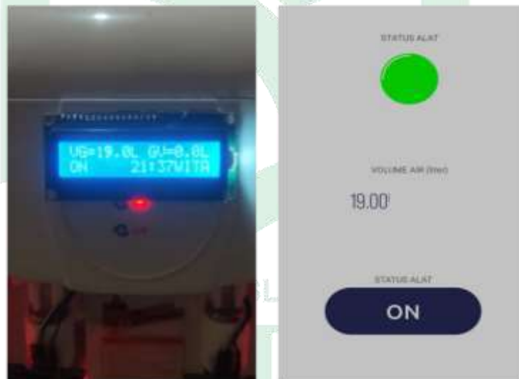
Gambar V.9. Pengujian Sensor Water Flow Pada LCD dan aplikasi mobile dengan volume air gallon 19.00 Liter.
