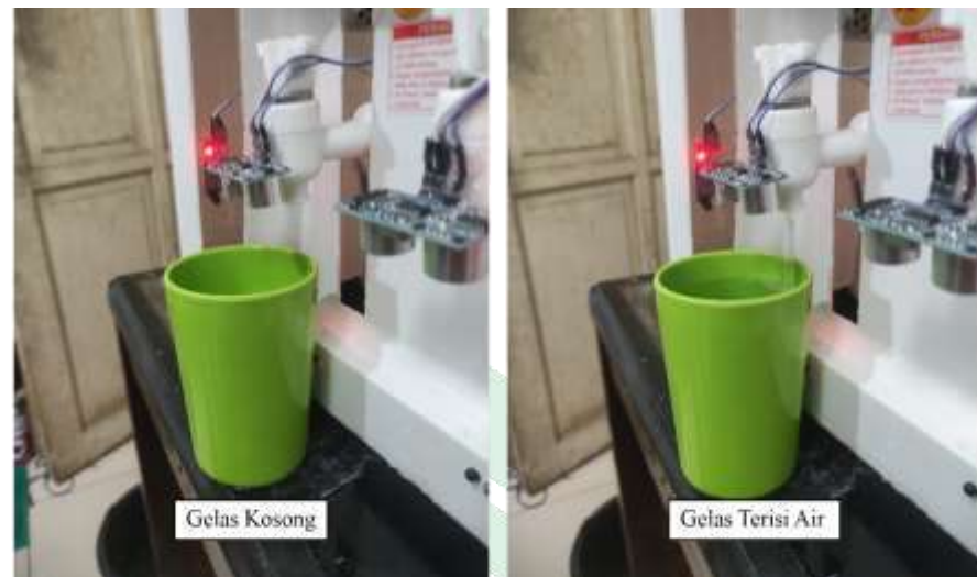
Gambar V.7. Pengujian Sensor IR (Infrared).
