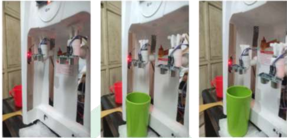
Gambar V.18. Pengujian sensor IR 1 untuk membaca keberadaan objek atau gelas dan IR 2 untuk membaca ketinggian gelas.
