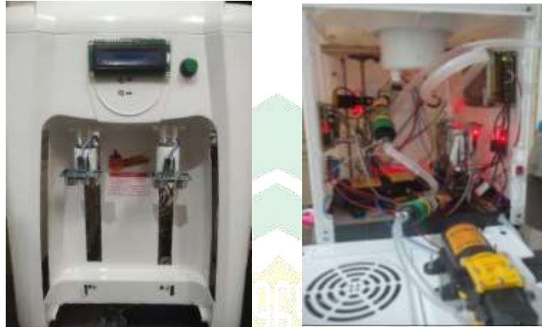
Tampilan depan dan isi Box Dispenser yang sudah dimodifikasi
