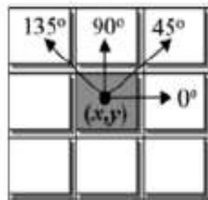
Gambar II. 6. Matrix GLCM dengan arah sudut  $0^\circ$ ,  $45^\circ$ ,  $90^\circ$ , dan  $135^\circ$
