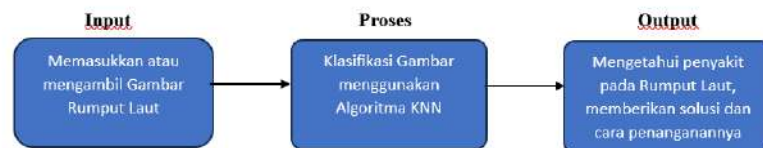
Gambar III. 2 Blok Diagram Pendeteksi Penyakit
