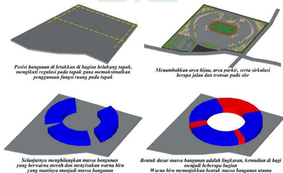
Gambar III 39. Transformasi Bentuk
