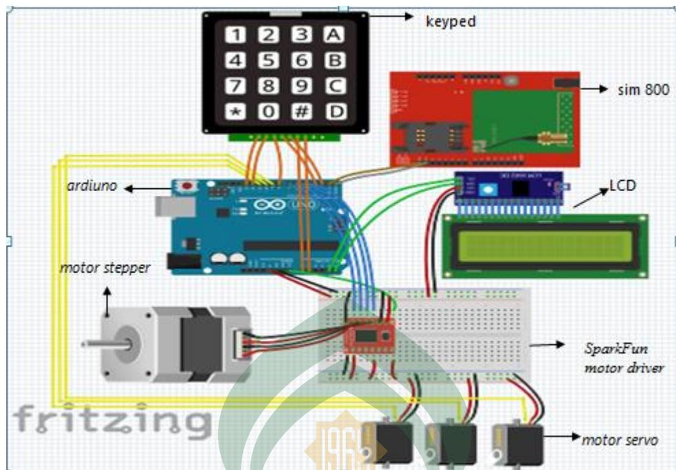
Gambar IV.3 Rancangan Desain Keseluruhan Alat
