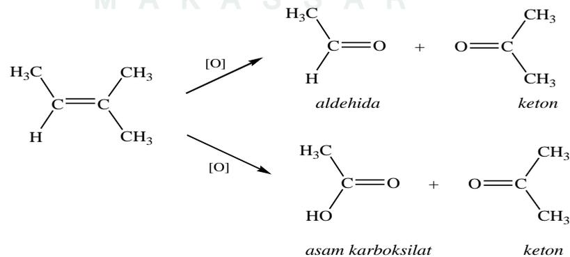
**Gambar 2.8 Reaksi Oksidasi Alkena Termonosubstitusi dan Terdisubstitusi**
