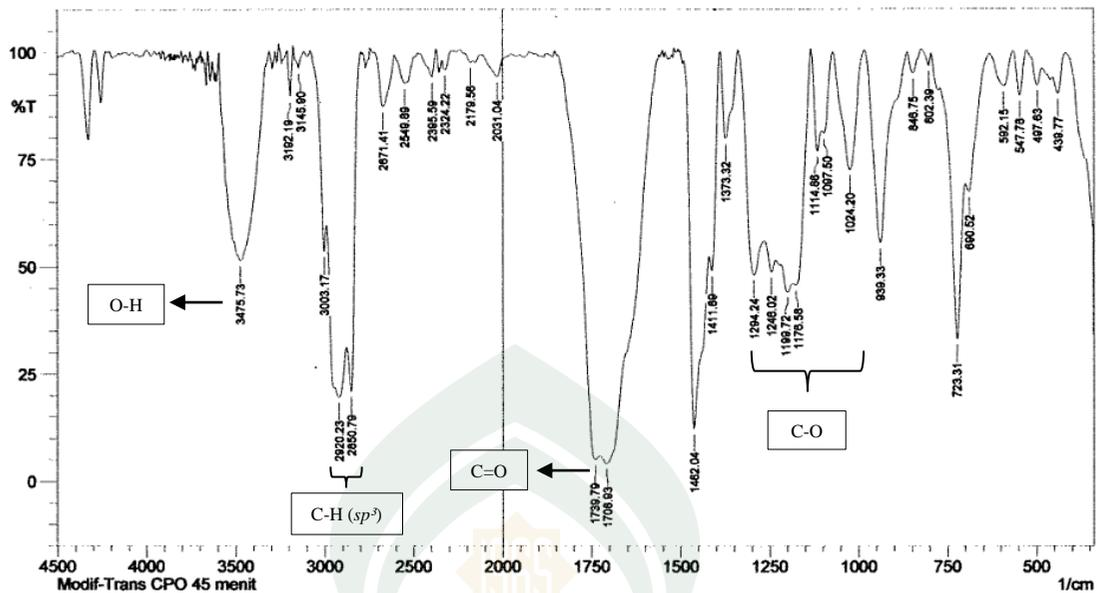
Gambar 4.2 Spektrum IR Biodiesel Variasi Oksidasi 45 Menit
