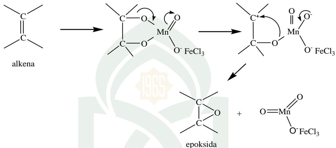
Gambar 2.5 Reaksi Pembentukan Epoksida
