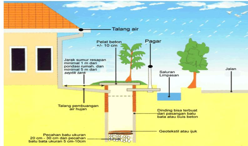
Gambar 2.2: Sumur Resapan
