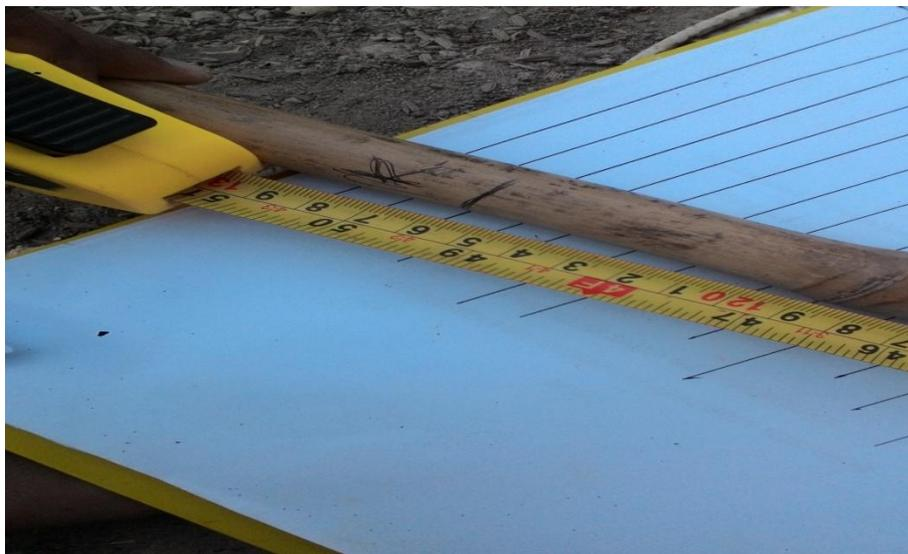
Gambar L.10: Pengukuran ketinggian air pada pipa sumur kontrol
