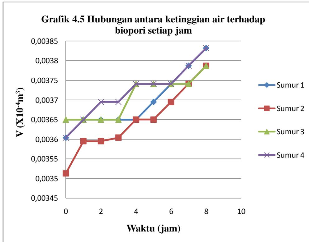
Grafik diatas menunjukkan bahwa pengaruh lubang resapan biopori dengan meresapkan  $0,0165 m^3$  pada hari ke 4 menunjukkan kenaikan volume air di dalam lubang resapan biopori dengan volume air yang didapatkan dapat dilihat pada sumur kontrol. Sehingga dapat diketahui bahwa dengan penambahan lubang resapan biopori yang lebih banyak maka akan didapatkan volume air yang lebih banyak karena memberikan daya tampung yang besar.
