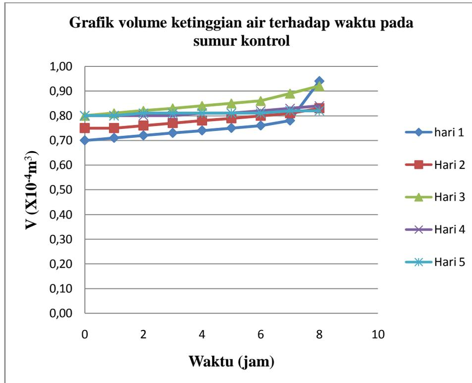
Grafik 4.8 menunjukkan bahwa pengaruh lubang resapan biopori menggunakan 4 lubang resapan biopori dan 1 lubang kontrol membuktikan bahwa volume ketersediaan air tanah mengalami peningkatan dengan data volume awal yang didapatkan 0,65 m pada hari pertama dan 0,81 m pada hari kelima sehingga peningkatan volume air yang didapatkan dapat dilihat pada sumur kontrol hari 1 sampai hari ke 3 terlihat peningkatan volume air sedangkan pada hari 4 dan 5 sumur kontrol sudah konstan terisi air.
