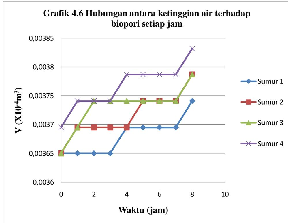
Grafik diatas menunjukkan bahwa pengaruh lubang resapan biopori dengan meresapkan  $0,016 m^3$  pada hari ke 5 menunjukkan kenaikan volume air di dalam lubang resapan biopori dengan volume air yang didapatkan dapat dilihat pada sumur kontrol dan untuk mendapatkan volume air yang lebih banyak maka perlu dibuatkan lebih banyak lagi lubang resapan biopori dengan diameter pipa paralon yang lebih besar.
