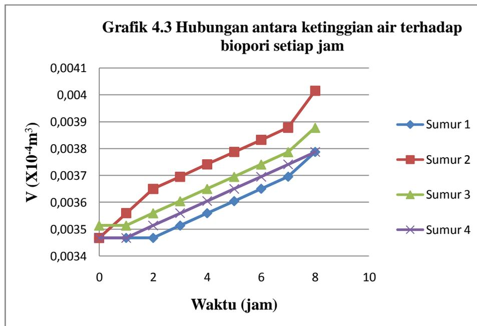
Grafik diatas menunjukkan bahwa pengaruh lubang resapan biopori dengan meresapkan  $0,016 m^3$  pada hari ke 2 menunjukkan kenaikan volume air di dalam lubang resapan biopori dengan volume air yang didapatkan dapat dilihat pada sumur kontrol. Disamping itu, jika ingin memperoleh volume air yang lebih banyak maka perlu dilakukan penanaman lubang resapan biopori yang lebih banyak lagi sehingga dapat memberikan daya tampung volume air yang lebih banyak.
