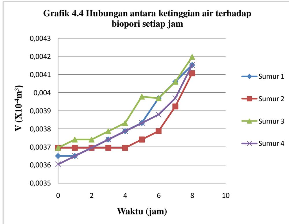
Grafik diatas menunjukkan bahwa pengaruh lubang resapan biopori dengan meresapkan  $0,0165 \text{ m}^3$  pada hari ke 3 menunjukkan kenaikan volume air di dalam lubang resapan biopori dengan volume air yang didapatkan dapa dilihat pada sumur kontrol. Disamping itu, jika ingin memperoleh volume air yang lebih banyak maka perlu dilakukan penanaman lubang resapan biopori yang lebih banyak lagi sehingga dapat memberikan daya tampung volume air yang lebih banyak.
