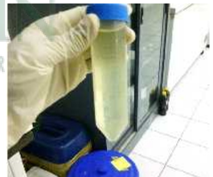
6. setelah crude enzyme diendapkan semalaman disentrifuge pada kecepatan 10.000 rpm di Laboratorium Bioteknologi terpadu fakultas ilmu peternakan UNHAS
