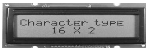
Gambar II.11 LCD tipe karakter 16x2
