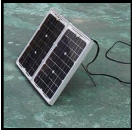
Solar cell berfungsi sebagai catu daya pada digitizer
