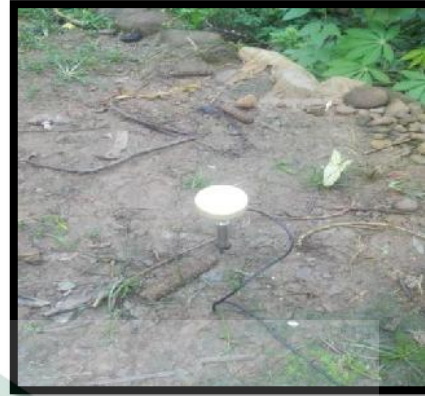
GPS antenna berfungsi untuk menentukan posisi pada setiap titik penelitian
