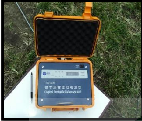
Digital Portable Seismograph TDL 303S berfungsi untuk merekam getaran tanah pada setiap titik penelitian
