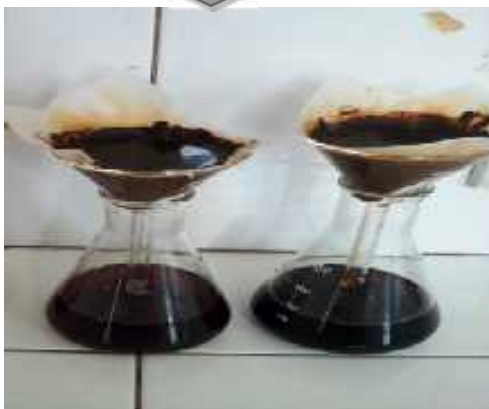
Endapan Lignin ditambahkan NaOH 1 N
