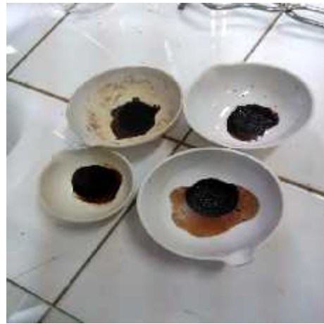
Pengujian Padatan Yang Tidak Menguap Perekat
