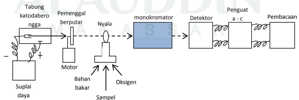
Gambar 3. Komponen-komponen suatu spektrofotometer serapan atom. (Day & Underwood, 2002: 425)
