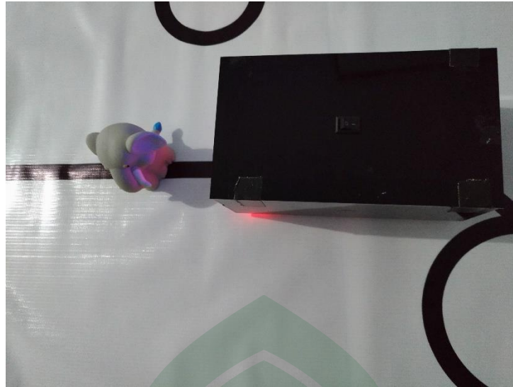
Gambar V.8 Kondisi ketika robot transportasi mendeteksi halangan.
