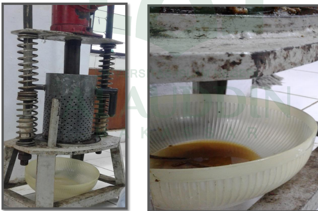
Gambar 14. Pengepresan biji karet menjadi minyak.
