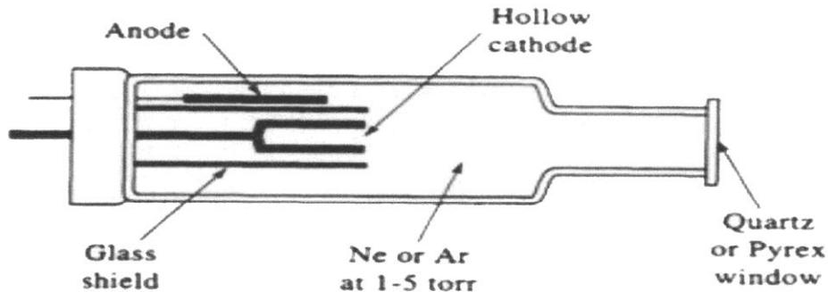
Gambar 3. Skema dari *Hollow Cathode Lamps*
