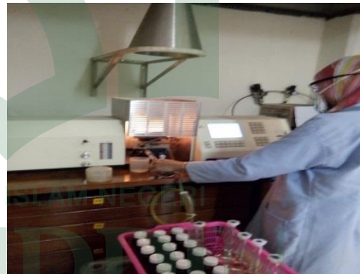
Pengukuran menggunakan alat SSA
