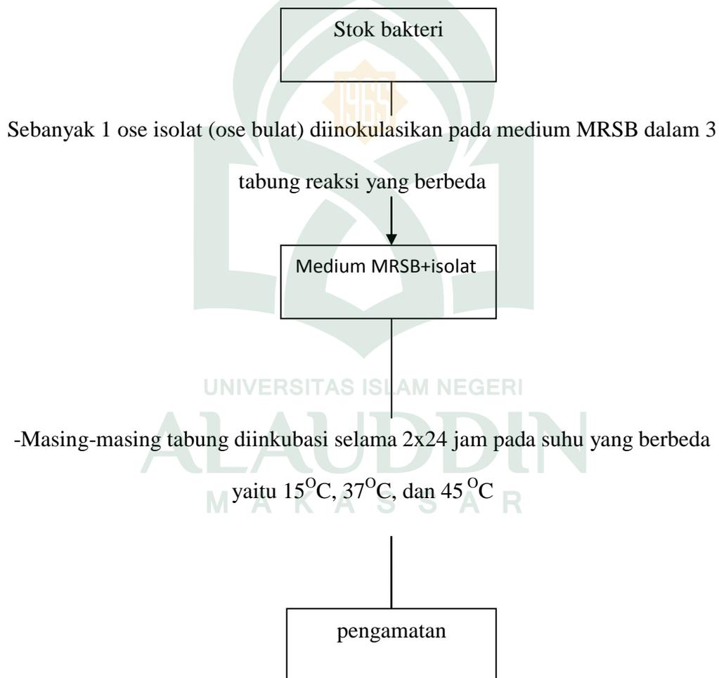
**Gambar 3 Skema kerja uji ketahanan Suhu  $^{\circ}\text{C}$**
