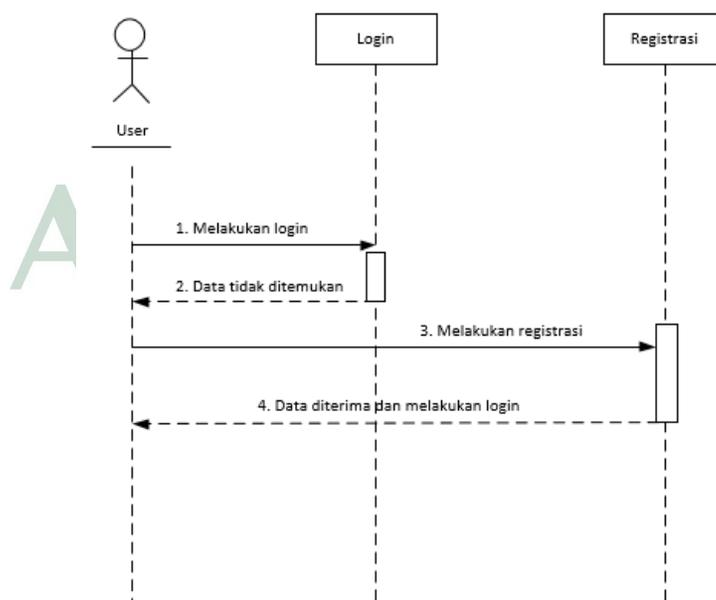
Gambar IV. 6. *Sequence Diagram Registrasi*
