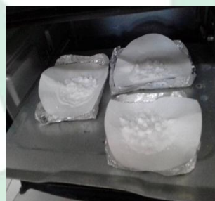
Mengoven silika gel pada suhu 120 °C selama 3 jam
