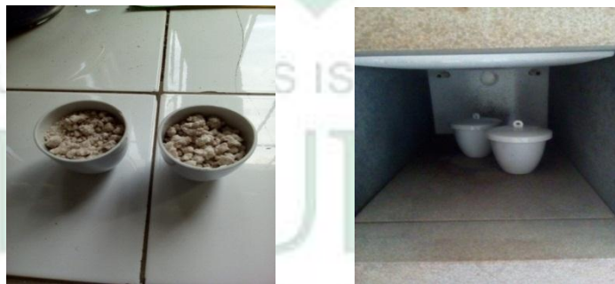
membakar sampel dalam tanur pada suhu 400\text{ }^{\circ}\text{C} selama 2 jam
