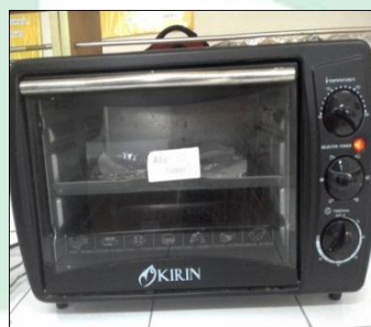
Mengoven silika gel pada suhu 120 °C selama 3 jam
