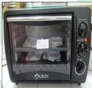
Mengoven gel (hidrogel) pada suhu 100 °C selama 6 jam
