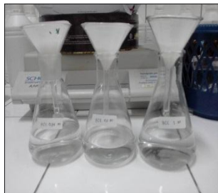
Menetralkan dan menyaring gel (hidrogel)
