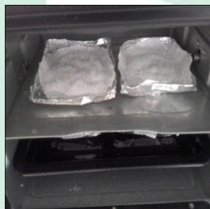
Mengoven gel (hidrogel) pada suhu 100 °C selama 6 jam
