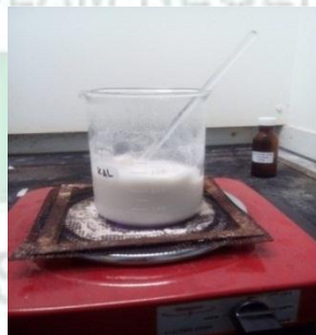
Pemanasan campuran serbuk kaca dan NaOH hingga mengental
