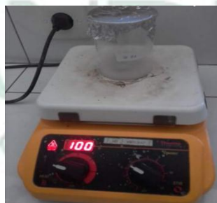
Dimagnetik stirrer pada suhu 100°C selama 1 jam
