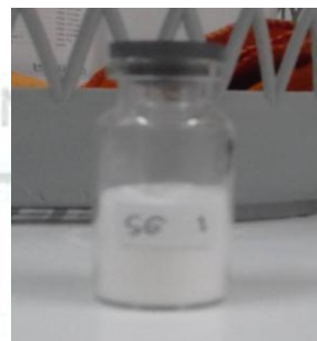
Mengoven silika gel pada suhu 120 °C selama 3 jam
