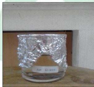
Natrium silikat ( \text{Na}_2\text{SiO}_3 ) yang tela disaring
