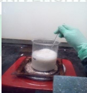
Pemanasan campuran serbuk kaca dan NaOH hingga mengental
