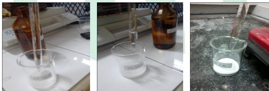
Penambahan asam klorida (HCl) 1 M pada silika gel
