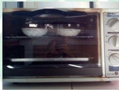
Memanaskan campuran serbuk kaca dan NaOH dalam oven pada suhu 120\text{ }^{\circ}\text{C}
