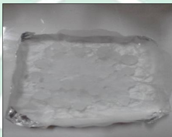
Hasil sintesis gel (hidrogel)
