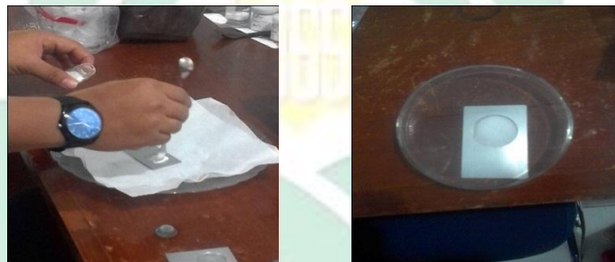
Memasukkan sampel silika gel ke dalam plat ( uji XRD)
