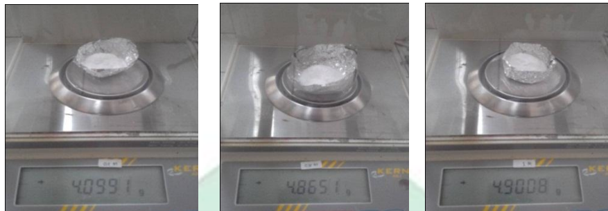
Hasil penimbangan massa silika gel hasil sintesis
