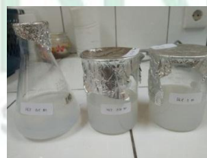
Pembentukan gel (campuran \text{Na}_2\text{SiO}_3 dan HCl)
